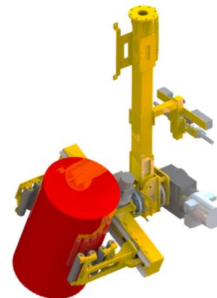
Электромеханический ГЗМ для бочек нескольких диаметров с функцией переворота
