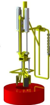
ГЗМ для кабельных катушек с функцией дополнительного подъема
